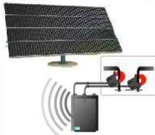
Paneles Solares - Equipo #5 - 1 Transmisor y 2 TC
